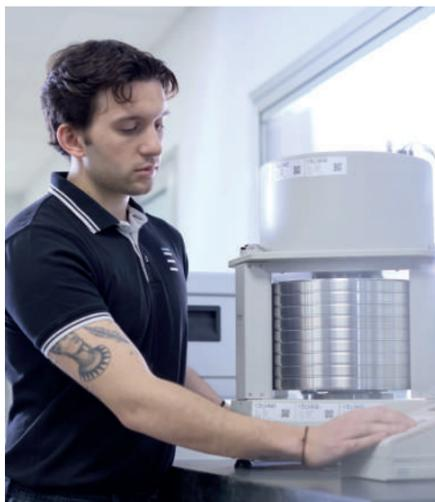
**Bilancia a pressione idraulica automatica**
